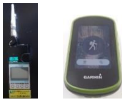
図1 ニオイセンサ（左） GPS ロガー（右）
