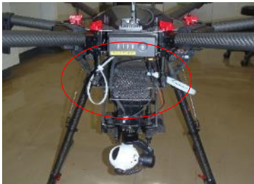
ニオイセンサを搭載できるようにドローンを改造。
