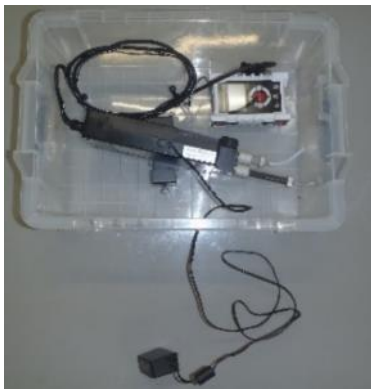
図3 データロガーを取り付けたニオイセンサ
