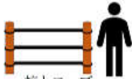
杭とロープ (ロープは複数本設置)
